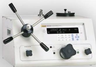
Электронный грузопоршневой манометр 6531, 6532
