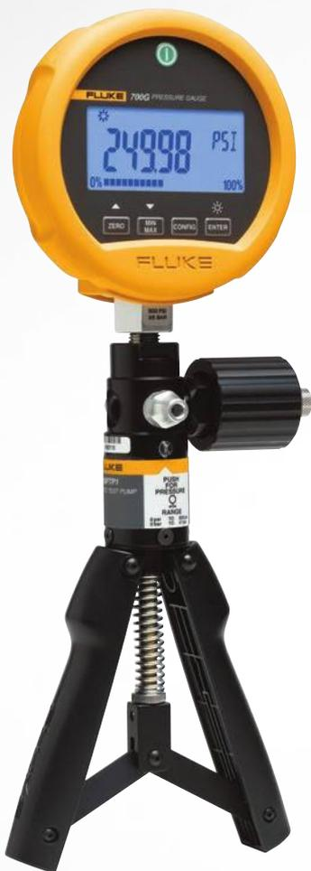
Важно выбрать правильный насос и манометр, соответствующие задачам тестирования. Можно руководствоваться правилом, что проверяющее устройство должно быть в 4–10 раз более точным, чем проверяемое устройство. Для достижения этой цели максимально совместите проводимые измерения со значением полной шкалы тестирующего манометра. Это обеспечивает наивысшую точность манометра.
