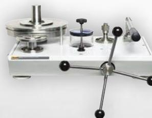
Гидравлические грузопоршневые манометры P3000
