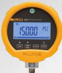
Манометры серии 700G — это высокоточные цифровые манометры для тестирования давления. Манометры серии 700G обеспечивают точность измерения до 0,04 % и могут использоваться в качестве калибровочного эталона или в любых других задачах, где требуется высокоточное измерение давления.
