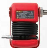
**Модули давления Fluke серии 700PEX** позволяют измерять давление с помощью искробезопасных калибраторов Fluke, таких как 718Ex и 725Ex. Модули давления измеряют давление с помощью внутреннего микропроцессора. Они получают питание от искробезопасных калибраторов и отправляют на них цифровую информацию.
