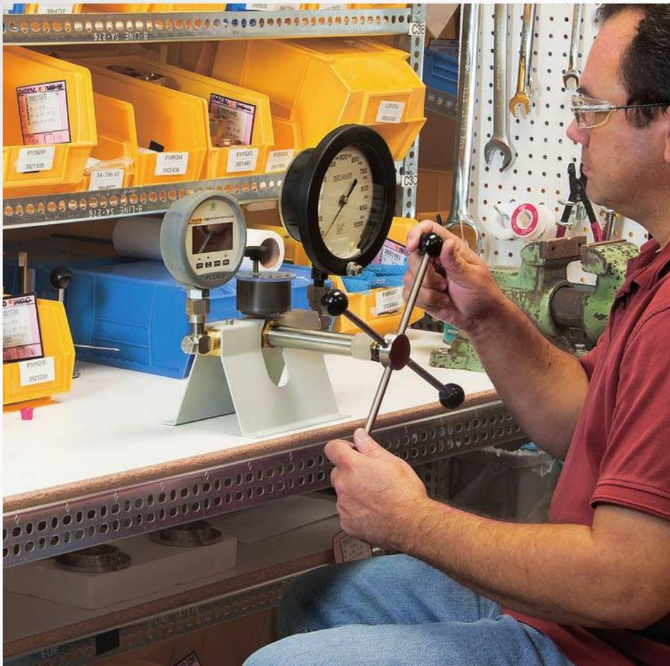
Компаратор давления — это удобный инструмент для калибровки давления на стенде. Калибровка на стенде выполняется для поддержания исходных условий и позволяет добиться наименьшей неопределенности. На стенде также можно легко осмотреть, скорректировать и отремонтировать проверяемое устройство.
