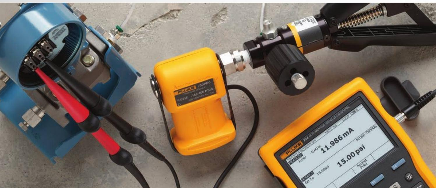
Классические методы тестирования реле давления остались в прошлом с введением новых инструментов для тестирования давления. Сегодня большинство реле давления тестируется при помощи манометра, установленного на насосе для подачи и измерения давления, и цифрового мультиметра, измеряющего непрерывность цепи, для проверки размыкания и замыкания реле. Техник или электрик, выполняющий тестирование, должен интерпретировать давление, приложенное к реле,
